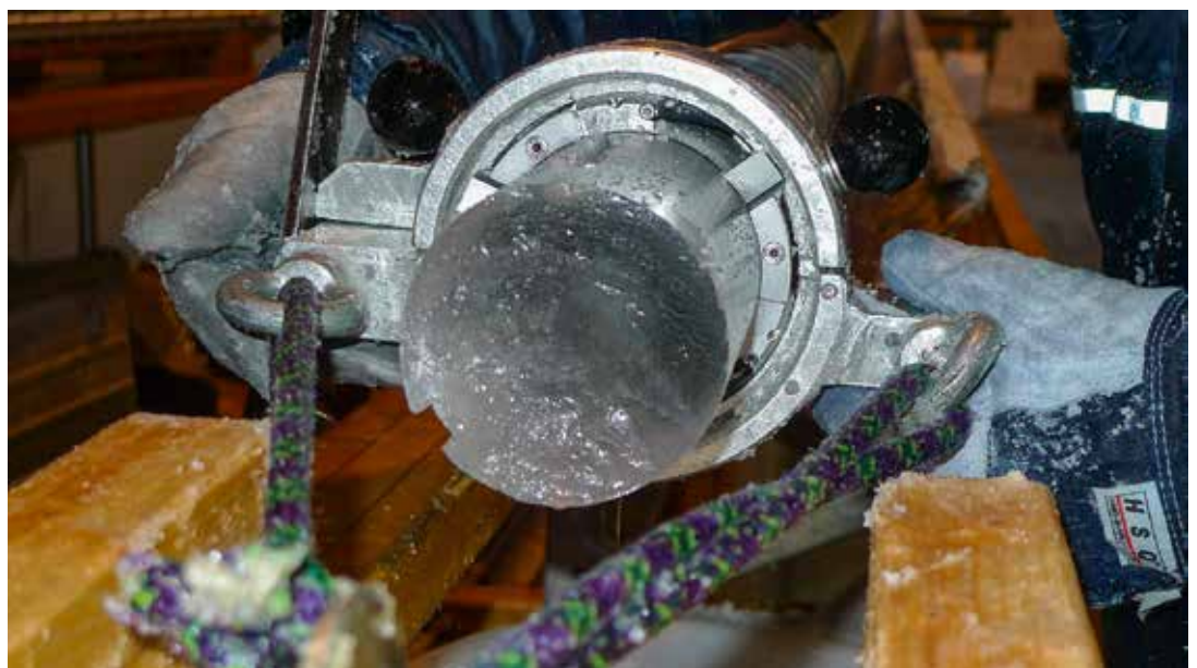
Abb. 1 Bohrkopf mit Eiskern. (Foto: Sepp KIPFSTUHL; NEEM ice core drilling project, http://www.neem.ku.dk )
